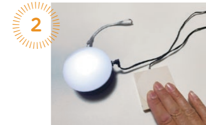
2 入力スイッチを押すとLEDが光ってブザーが鳴ります。
